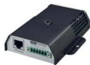
EMD (Dispositivo de monitoreo ambiental) para que pueda operar se necesita tener la SNMP instalada
